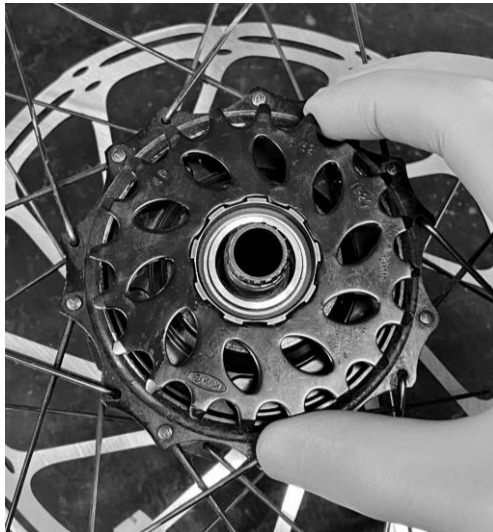
4.1: Install sprocket.
